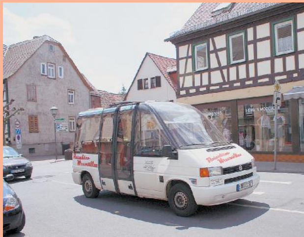
Zur Eröffnung des Citybus-Verkehrs stellte man 1992 einen der ersten gebauten Ernst Auwärter Microstar mit VW-Triebkopf in Dienst. Er befindet sich nicht mehr im Fuhrpark, hier ist aber ein baugleiches Fahrzeug zu sehen. >>
