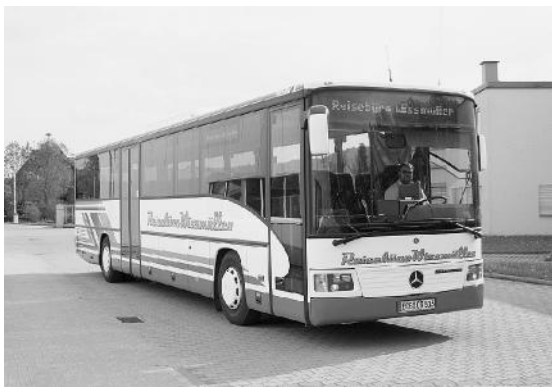
In der Nachfolge des O 407 wurden mehrere MB Integro beschafft, sowohl in der 12 m langen Normalversion als auch in der 12,8 m langen M-Variante (Bild). >>
